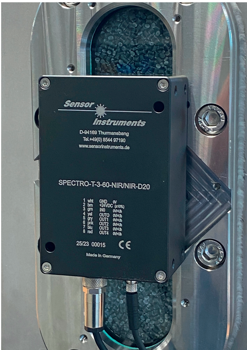
Der NIR-Inline-Sensor Spectro-T-3-60-NIR/NIR-D20 wird an Schaugläsern von Dosieranlagen und Silos montiert. © Sensor Instruments
